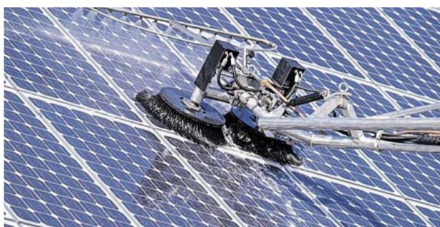
Zwei gegenläufige Bürsten, darüber ein feiner Hochdruckstrahl und reichlich Wasser: Damit werden Photovoltaik-Module wieder „sonnenklar“.
